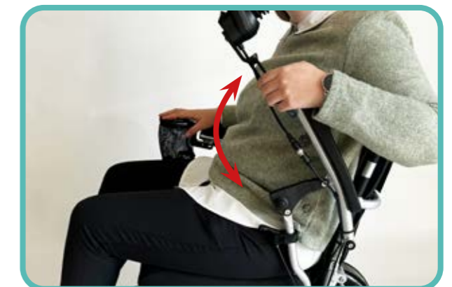
B2 Nach dem Anheben auf die maximale Höhe lassen Sie einfach los. Wenn Sie in die Ausgangsposition zurückkehren möchten, drücken Sie die Armlehne nach unten, bis sie einrastet.
